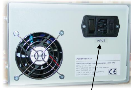
Interruttore e presa IEC di alimentazione
